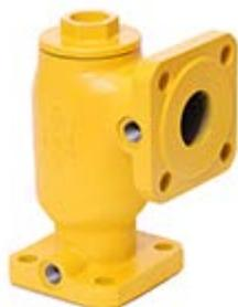
Сетчатый газовый фильтр высокой очистки угловой **ФГС-50ВО-У** используется для очистки природного газа, воздуха, азота и других газов неагрессивного типа от механических примесей, в диапазоне температур окружающей среды от - 40 С до + 70 С. Применяемый фильтрующий элемент – сетка полутомпаковая. До фильтрующего элемента и после него в корпусе имеются резьбовые отверстия для присоединения индикатора перепада давления.
