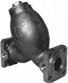
Газовый фильтр сетчатый **ФГ-50С** используется для очистки газов неагрессивного типа и воздуха от окалин и пыли и других механических примесей. Применяемый фильтрующий элемент - сетка полутомпаковая, с ячейкой 0,5 мм ГОСТ 6613-86.
